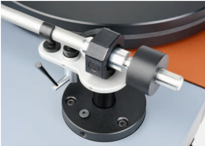
Konventionelle Höhenverstellung mittels Klemmschraube, kardanisches Lager und (zukünftig) Antiskating per Feder: der PE-Tonarm.
